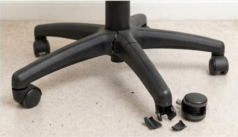
BASE Y PATAS DAÑADAS
