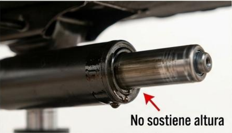
PISTÓN DE GAS DEFECTUOSO
